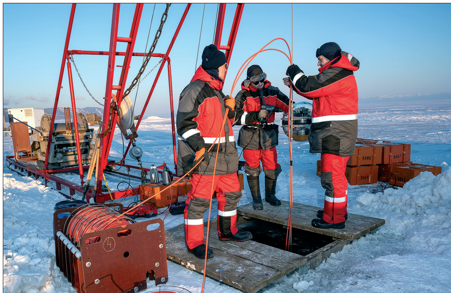
Установка 4700-го оптического модуля телескопа Baikal-GVD
