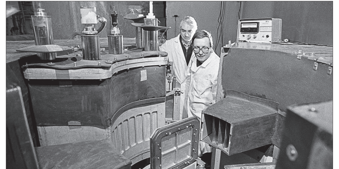
Спектрометр неупругого рассеяния нейтронов в обратной геометрии НЕРА-ПР. Л. С. Смирнов и И. Натканец. 1992 год
