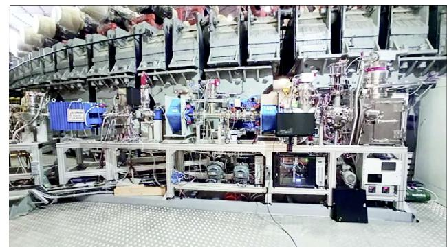
Осенью 2021 года в ЛФВЭ были проведены работы по монтажу оборудования станции СОЧИ и канала транспортировки, включая модернизацию начальной части канала инъекции пучка в бустер, ответвлением которого является канал станции СОЧИ.
