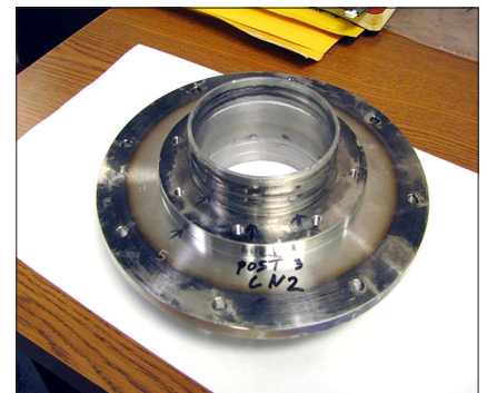
Nb+SS переходник с обнаруженными точками течи.
