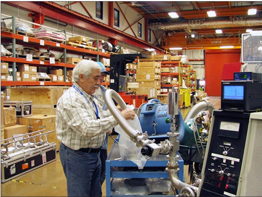
Б. М. Сабиров проводит измерения течи с впрыснутым газом He в полиэтиленовый пакет, в который помещен образец.
