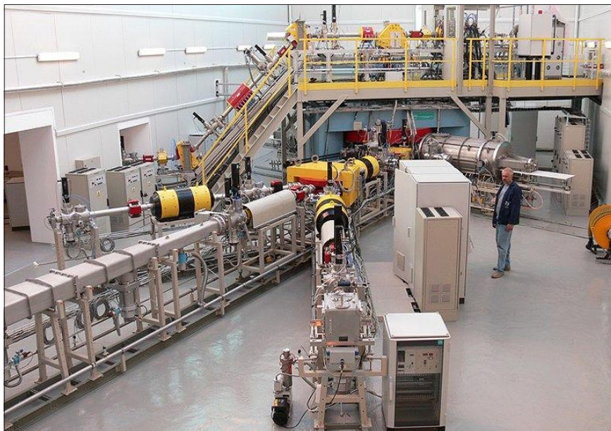
На снимке Юрия ТУМАНОВА: ускоритель тяжелых ионов DC-60, созданный в Дубне, стал базой для инновационных работ и подготовки специалистов Республики Казахстан.
