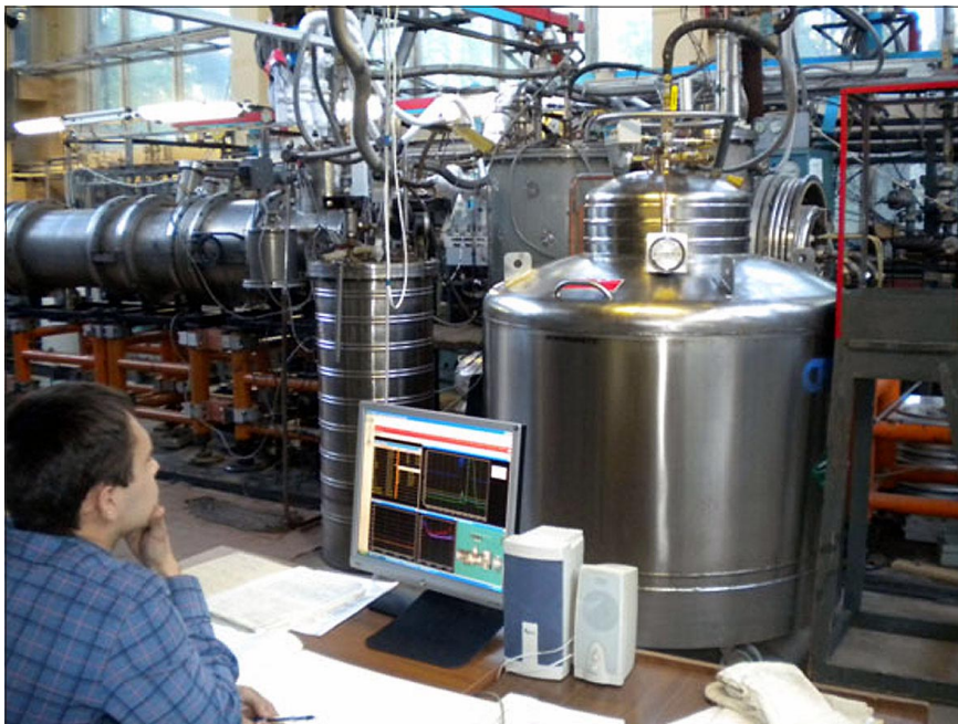
Криогенные испытания полномасштабного прототипа сверхпроводящего дипольного магнита для бустера NICA.
