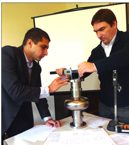
На снимке: Н. С. Азарян и Д. Л. Демин изучают «заморского гостя» – ниобиевый резонатор, полученный из FNAL.
