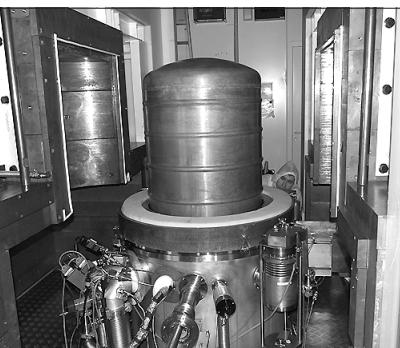
Криостат растворения, внутри которого находятся HPGe детекторы при температуре в 20 мК.
