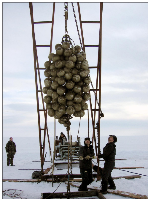
Буй демонтирован – доступ к электронике и оптическим модулям гирлянды открыт.
