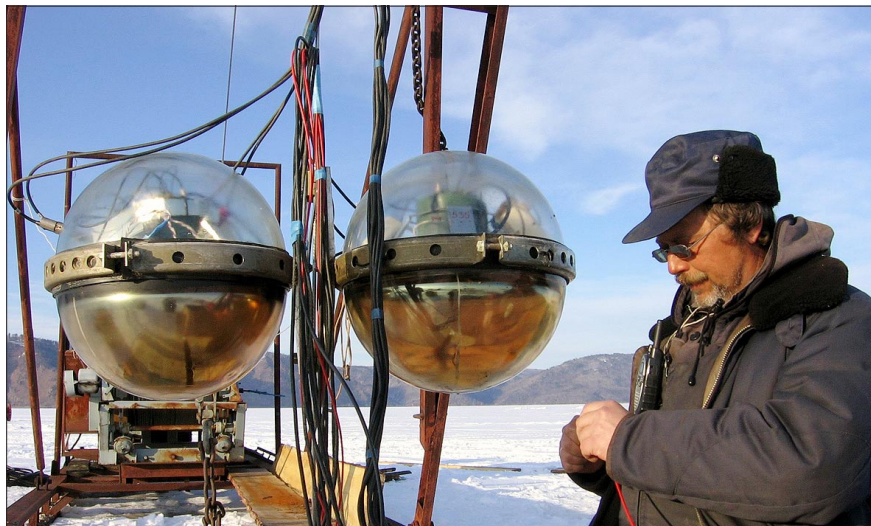
Монтаж оптических модулей.
