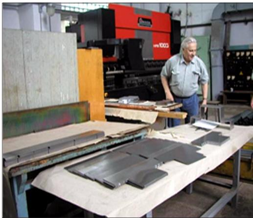
Отработка технологии изготовления корпусов аэрогелевого детектора в ОП ОИЯИ. Один из участников эксперимента PHENIX Л. С. Золин.
