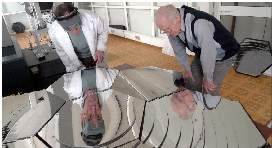
На снимке Юрия ТУМАНОВА: сотрудники ЛЯП С. Ю. Пороховой и Л. Г. Ткачев проверяют состояние отражающей поверхности зеркала после проведения предварительных испытаний при перепадах температуры \pm 80^\circ C .
